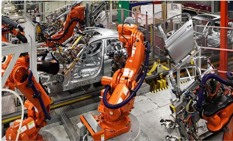
Figure II.3 : Bras manipulateur robotisé dans une chaîne de production
