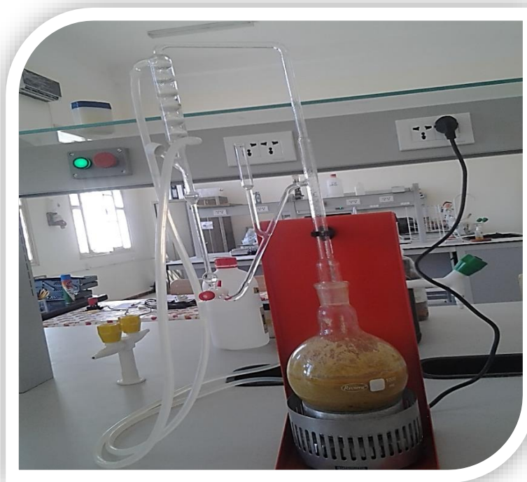
Photo 03 : Montage d'extraction des huiles essentielles à partir des feuilles de Pergularia tomentosa par Clevenger
