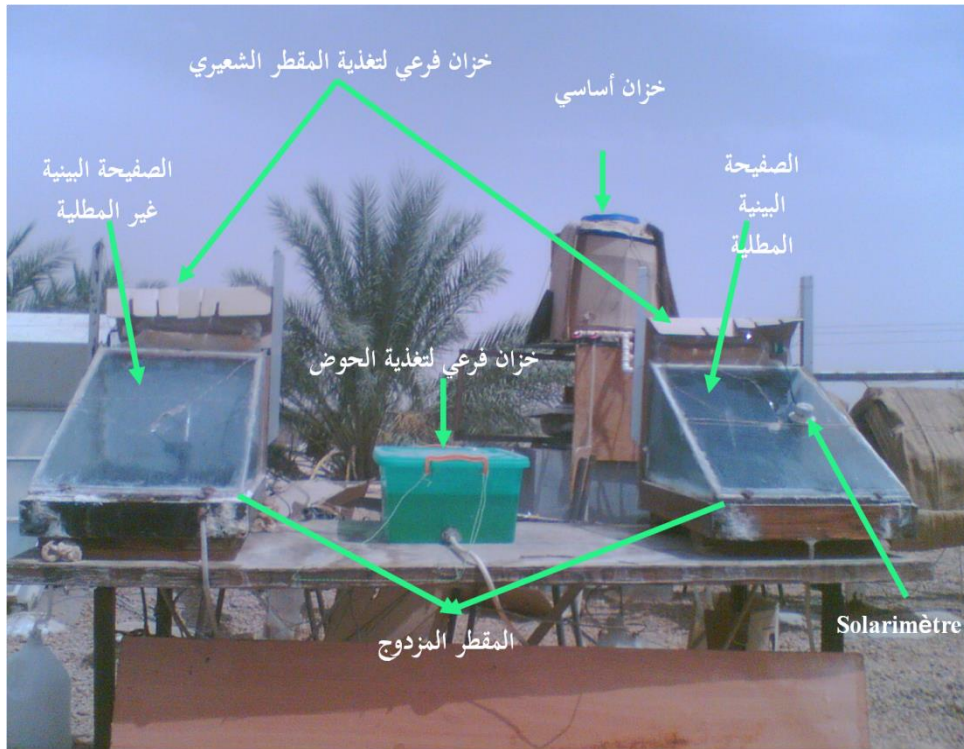
الشكل 6.B: رسم تخطيطي للتركيب التجريبي على المقطر المزدوج 06/08/2007
