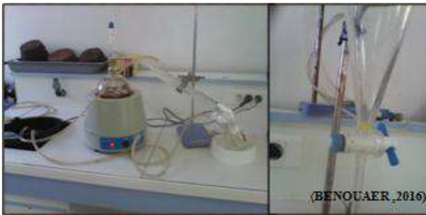
Photo 03 : Montage de l'Hydrodistillation employé pour l'extraction des huiles essentielles (CLEVENGER, 1928).
