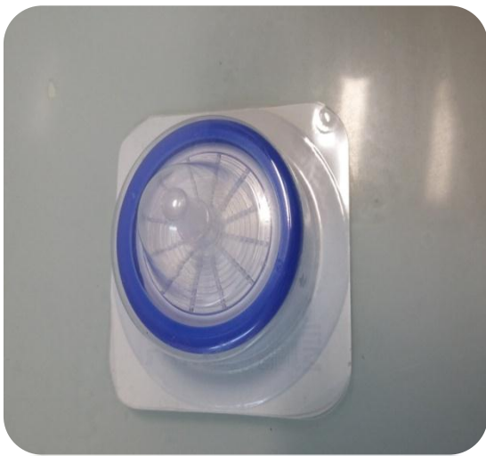
Photo 11 : la filtration d'extrait aqueux de citrullus colocynthis par micro filtre.
