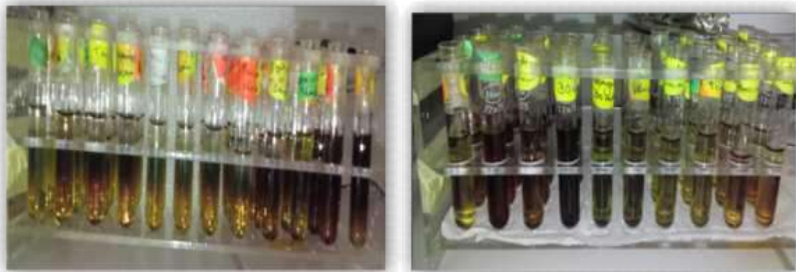
Figure (34): Coloration de milieu réactionnel dans le dosage des tanins
