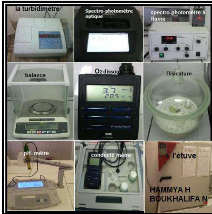
**Photo 04.** Quelques appareils utilisés lors des analyses physico-chimiques
