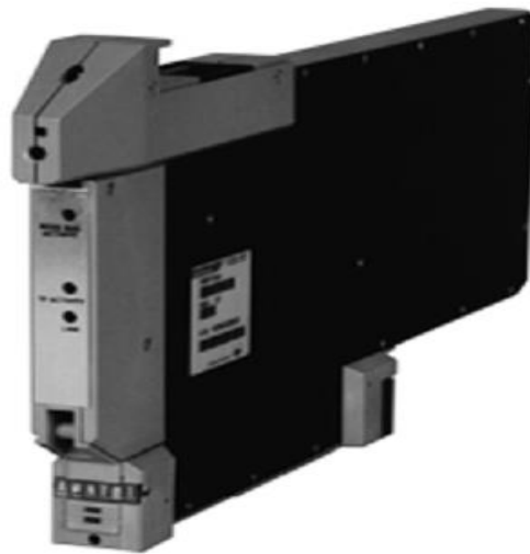
Figure II.9 : Vue d'un module (dual node bus interface)
