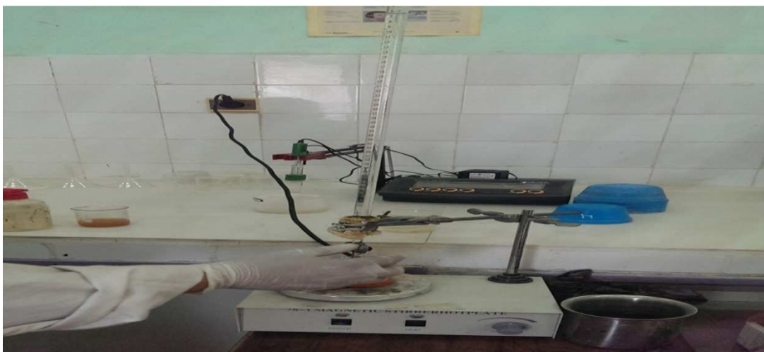
Fig. 23 : Photo montrant l'ajout de chlorure de baryum sur mélange filtré.
