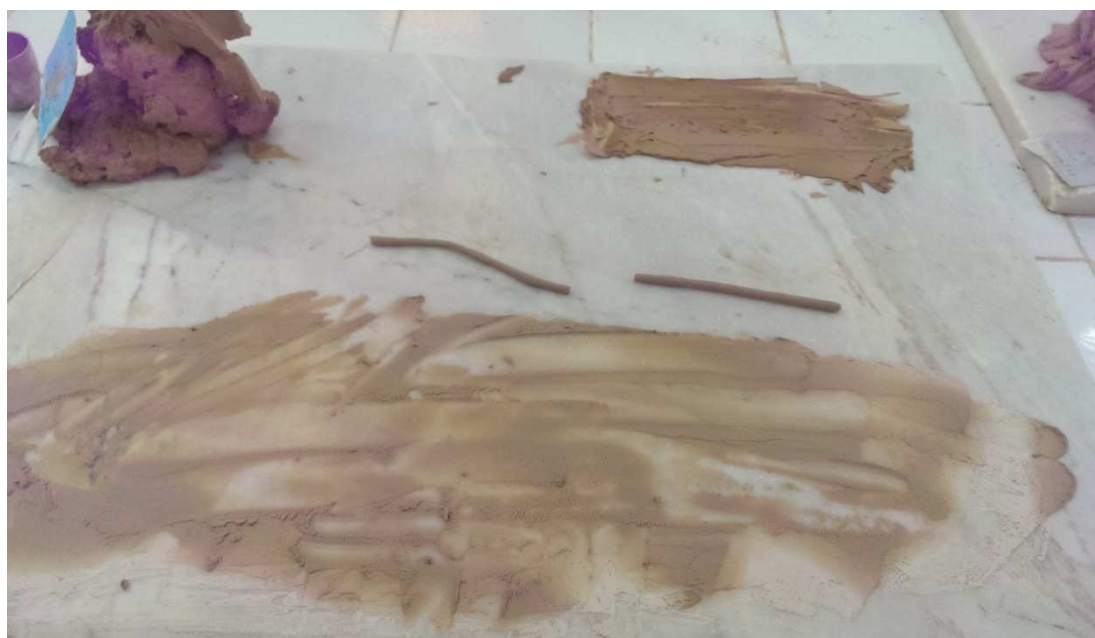
Fig. 19 : La mesure des limites de plasticité des différents échantillons.
