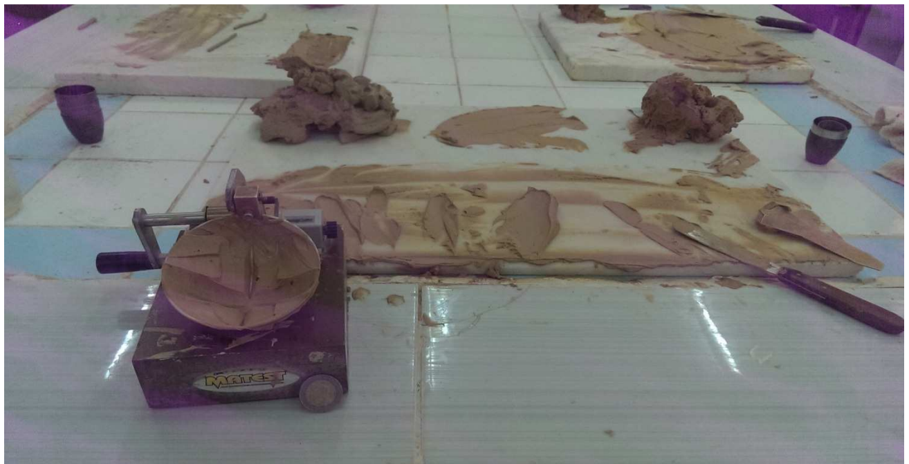
Fig. 18 : Photo montrant l'appareil de casa grande pour déterminer la limite de liquidité.
