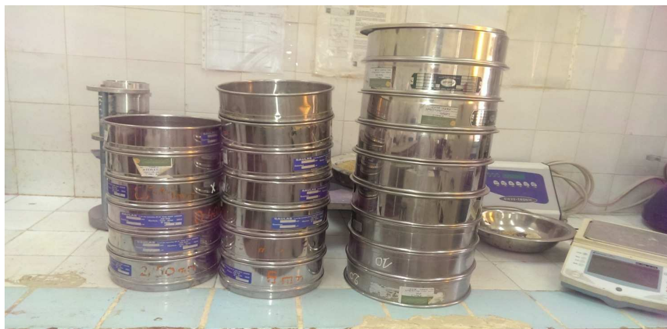
Fig. 13 : Photo montrant le mode opératoire de l’essai de tamisage.
