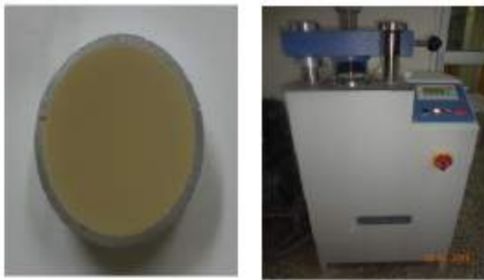
الشكل II-26: جهاز ضغط العينات و نموذج إحدى العينات في تقنية ED-XRF
