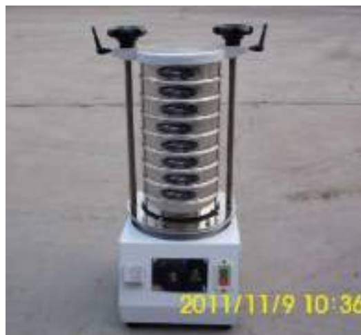
الشكل I-12 المناخل المستخدمة في تحديد البعد الحبي للرمل [34]
