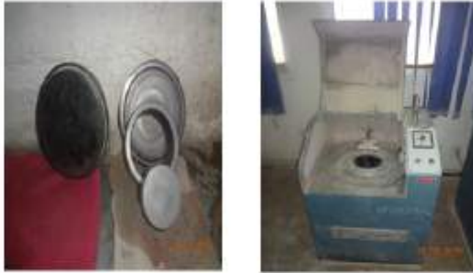
الشكل II-25: جهاز الطحن و إنائه المستخدم في تقنية ED-XRF
