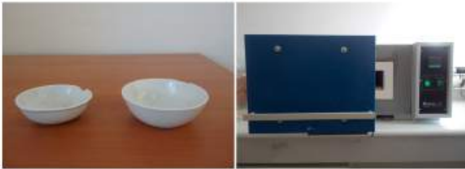
الشكل II-3: الفرن الكهربائي المستخدم للتسخين و الأواني الخزفية
