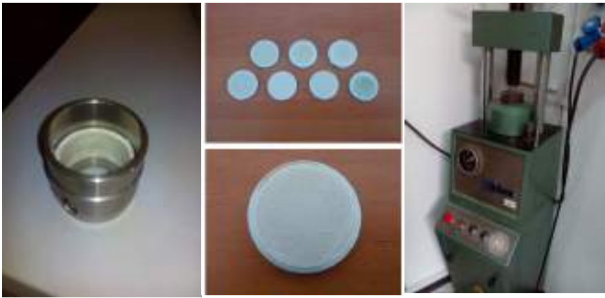
الشكل II-27: جهاز ضغط العينات و نموذج إحدى العينات في تقنية WD-XRF
