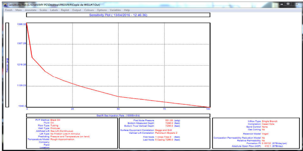
FIG : IV.7- LES VARIATIONS DE LA PRESSION DE FOND EN FONCTION DE LA QUANTITE DE GAZ INJECTEE
