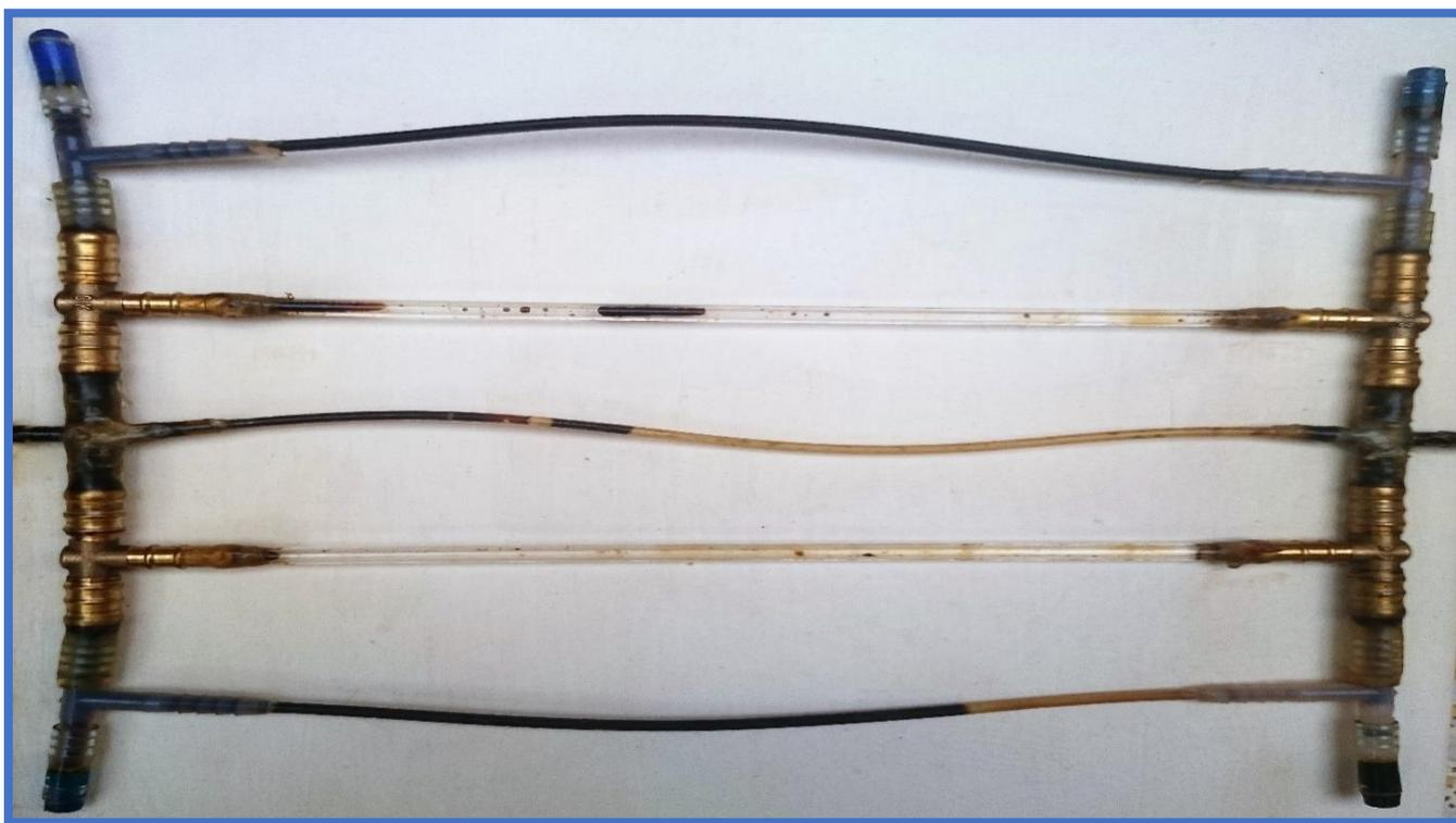
*Figure (62) : Image de drainage d'huile brute par l'eau dans le modèle capillaire Mixte-Wet.*
