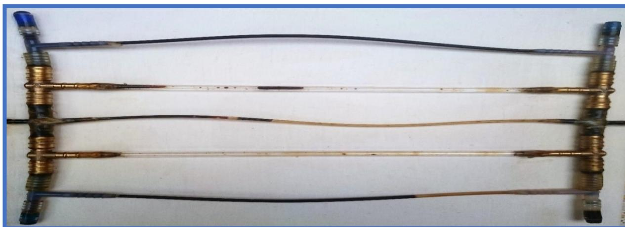
Figure (37) : Image de drainage d'huile brute par l'eau dans le modèle capillaire Water-Wet.
