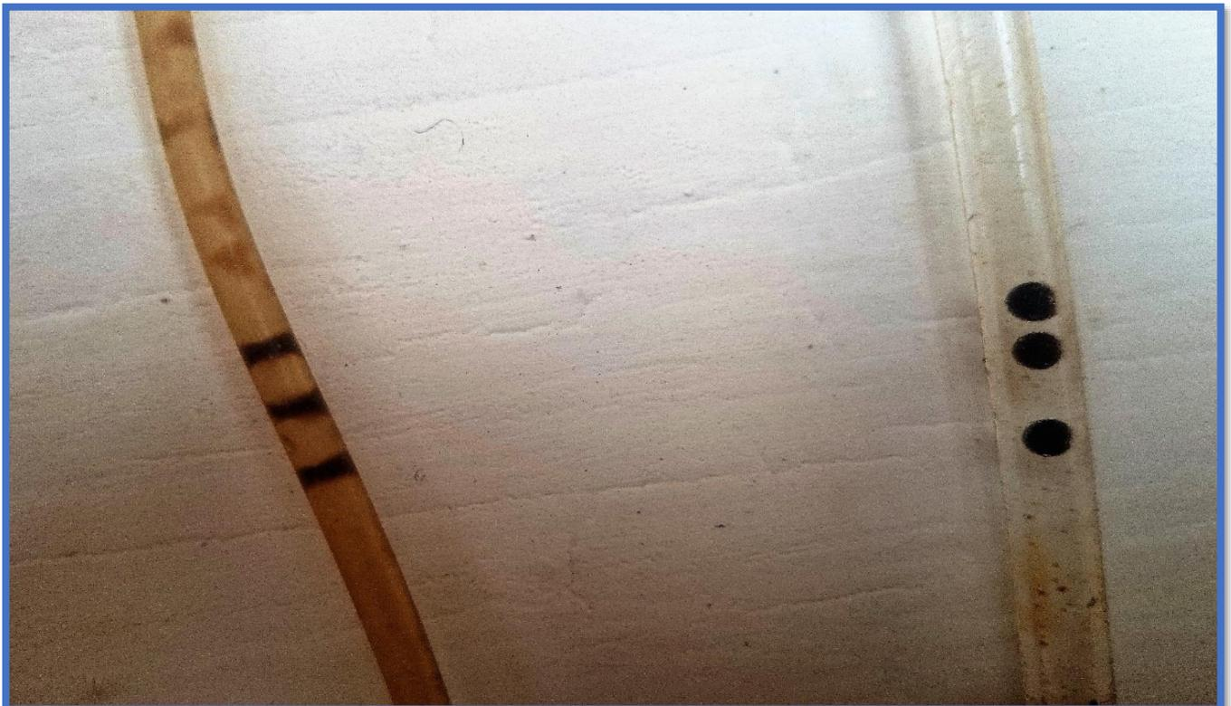
Figure (58) : Image représente les différentes mouillabilités dans le modèle Mixte-Wet.
