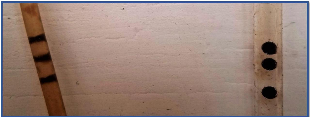
Figure (34) : Image d'une partie de modèle capillaire Mixte-Wet qui représente les types de mouillabilité.
