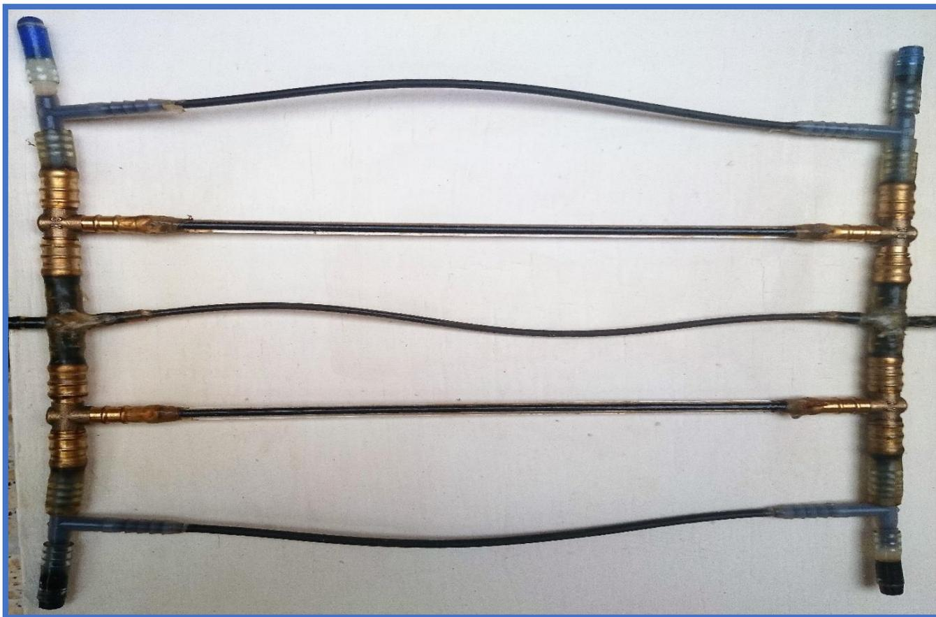
*Figure (61) : Image de modèle capillaire Mixte-Wet remplie par l'huile brut.*
