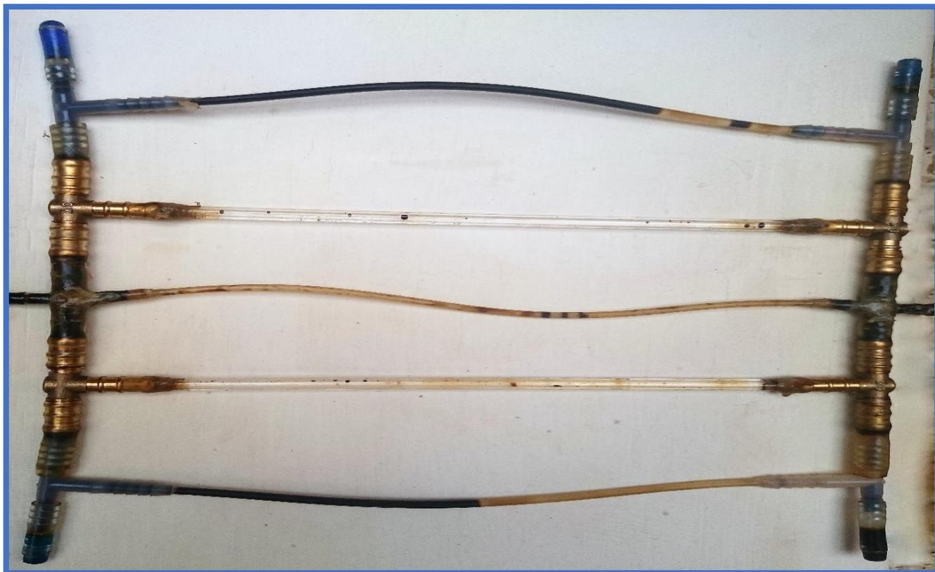
Figure (63) : Image de drainage d'huile brute par l'eau carbonatée dans le modèle capillaire Mixte-Wet.
