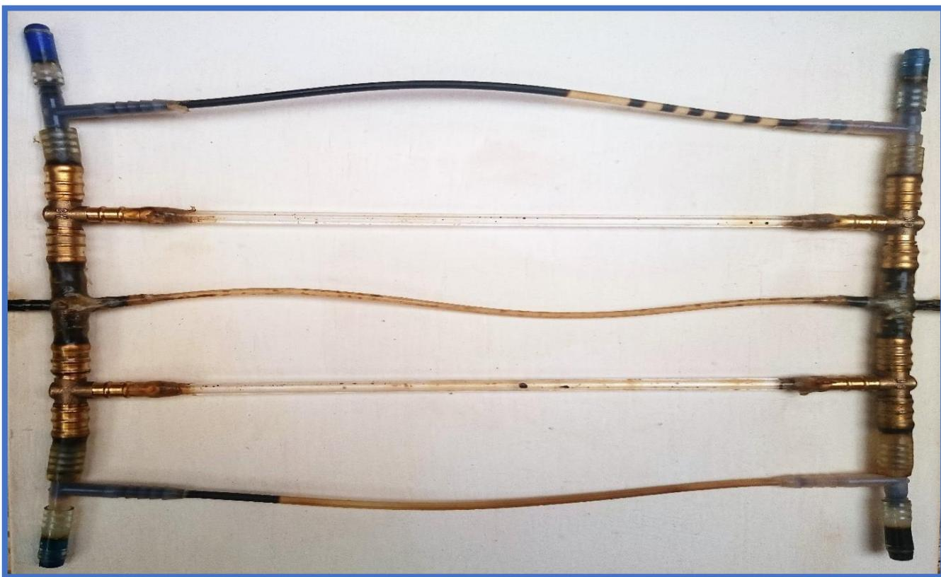
Figure (64) : Image de drainage d'huile saturée en  $\text{CO}_2$  par l'eau carbonatée dans le modèle capillaire Mixte-Wet .
