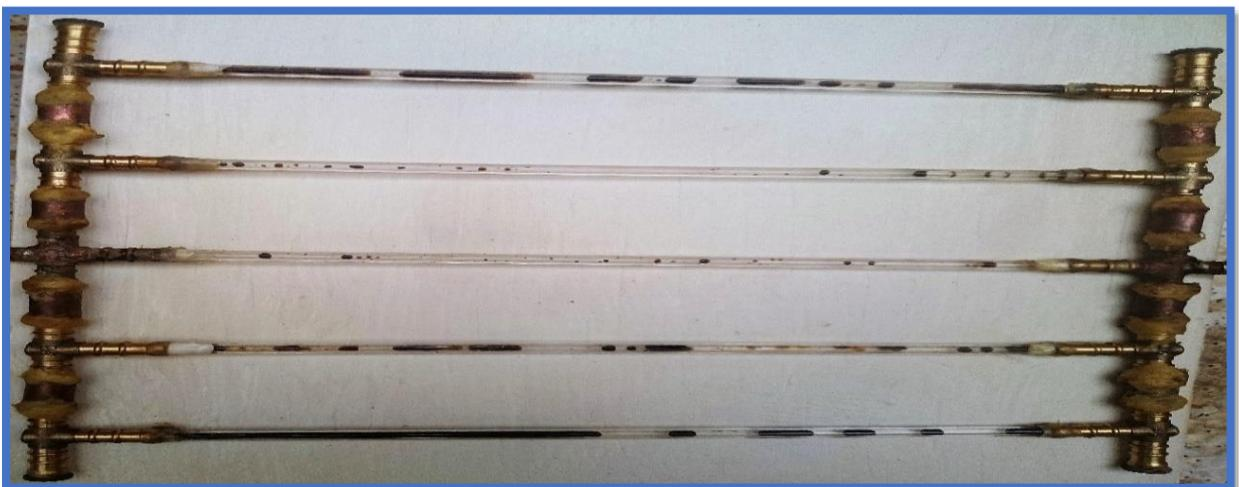
Figure (38) : Image de drainage d'huile brute par l'eau dans le modèle capillaire Water-Wet.
