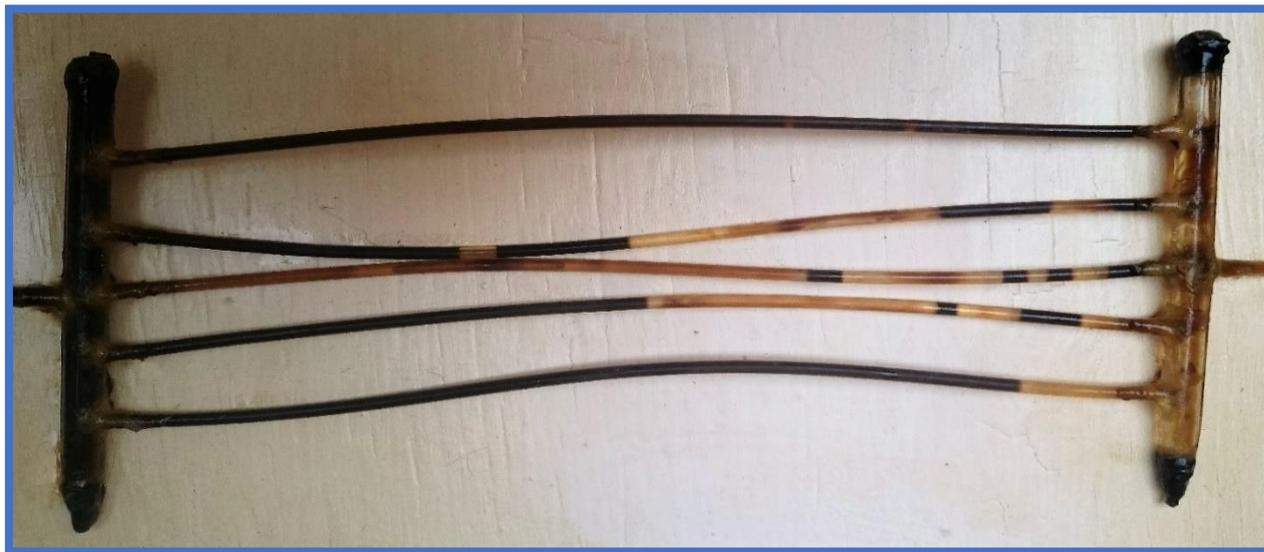
Figure (36) : Image de drainage d'huile brute par l'eau dans le modèle capillaire Oil-Wet.
