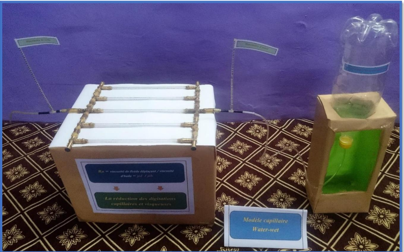
Figure (56) : Image de modèle capillaire Water-Wet.
