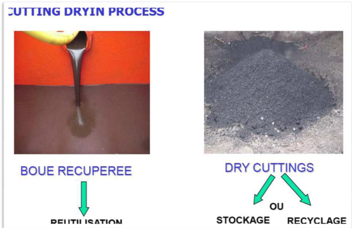
Figure IV.7 : Les déblais de forage après le traitement (Document SONATRACH 2010).
