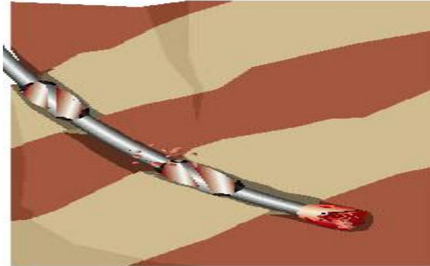
Figure N°II.10: Diminution du diamètre nominal du trou
