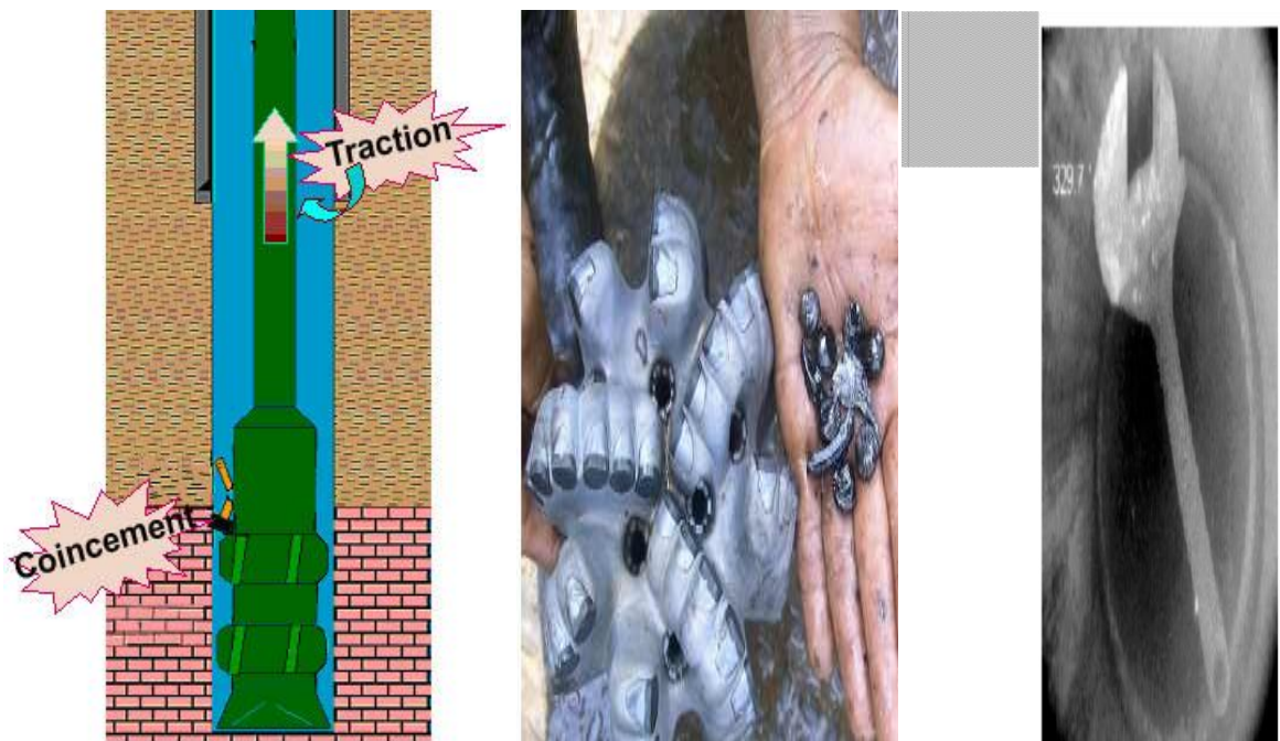
Figure N°II.04: chute de ferraille dans le puits.
