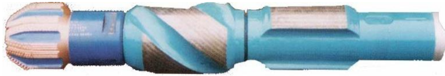
Fig24 : Extrémité femelle Bit Box Stabiliser + outil standard (2)
