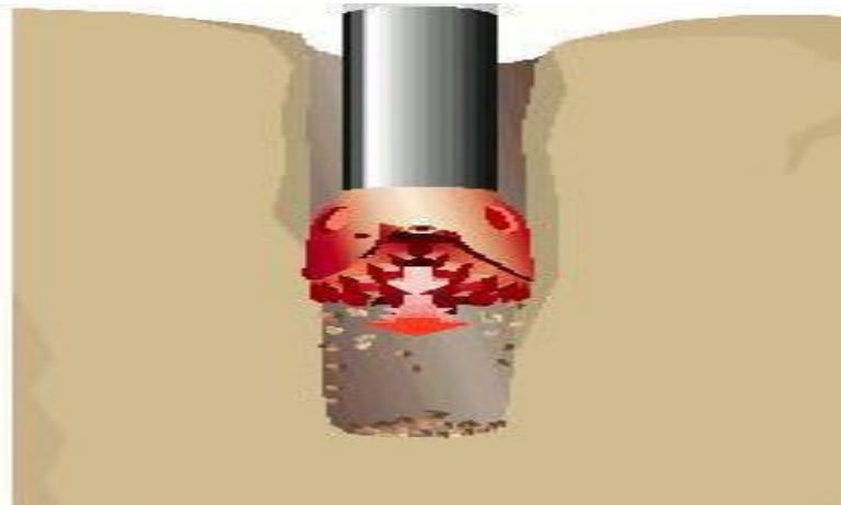
Figure. II.10: Diminution du diamètre nominal du trou.
