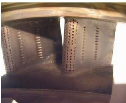
Figure II-12: Aube refroidie par film
