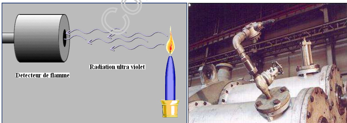
Fig.II.4 : Détecteur de flamme
