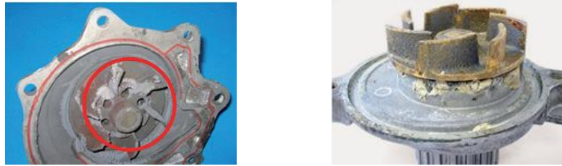
Fig. (III.5) : Pompe à eau corrodée et entartrée
