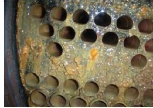
Fig. (III.7) : refroidisseur d 'huile Fig. (III.8) : refroidisseur d 'huile corrodée
