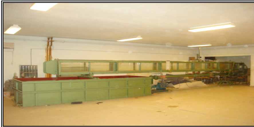
Fig. 03. Canal à ciel ouvert en laboratoire pour l'expérimentation de l'effet du roseau sur l'écoulement
