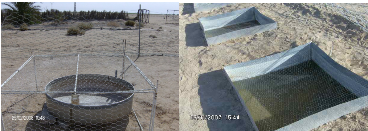
Figure 2. Bacs d'évaporation Classe « A » et Colorado
