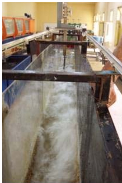
Photographie 2 : Ressaut hydraulique en canal profilé en U à fond demi-circulaire rugueux. a) Vue à l'amont du ressaut. b) Vue à l'aval du ressaut
