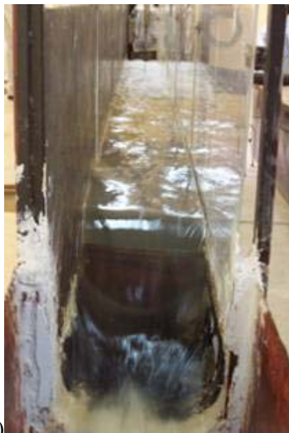
Photographie 2 : Ressaut hydraulique en canal profilé en U à fond demi-circulaire rugueux. a) Vue à l'amont du ressaut. b) Vue à l'aval du ressaut
