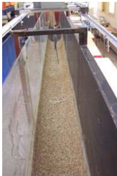
Photographie 3 : a) Echantillon de grains de gravier de rugosité équivalente \varepsilon = 7,14 \text{ mm} b) Grains de gravier répartis uniformément sur le fond du canal.
