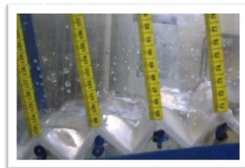
Photo 2- Ecoulement en nappe pour les faibles débits, modèle (A)
