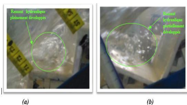
Photo 3- (a): Ressaut hydraulique pleinement développé pour les moyens débits (modèle A, \alpha=30^\circ ). (b) : Ressaut hydraulique partiellement développé pour les moyens débits (modèle A, \alpha=30^\circ ).
