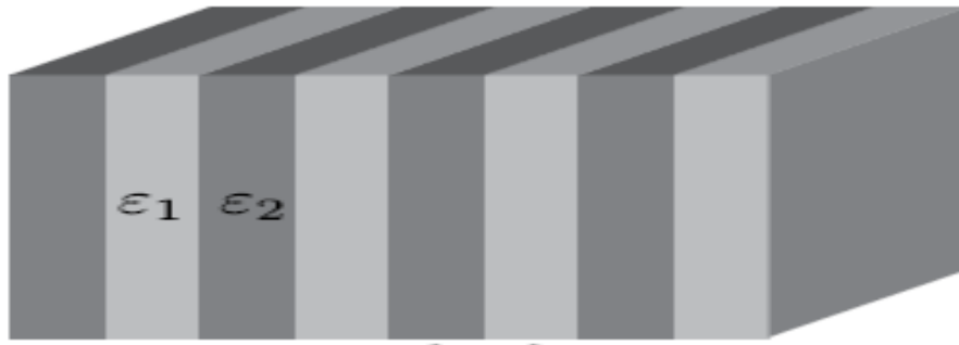
Figure.I.7: Schéma d'un miroir de Bragg constitué d'un milieu diélectrique périodique fini.
