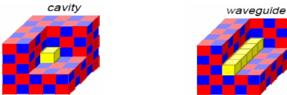
(a) 3-D Défaut de cavité (ponctuel)
