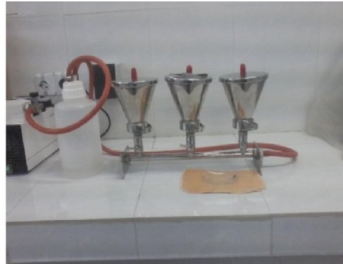
Dispositif de filtration sous vide
