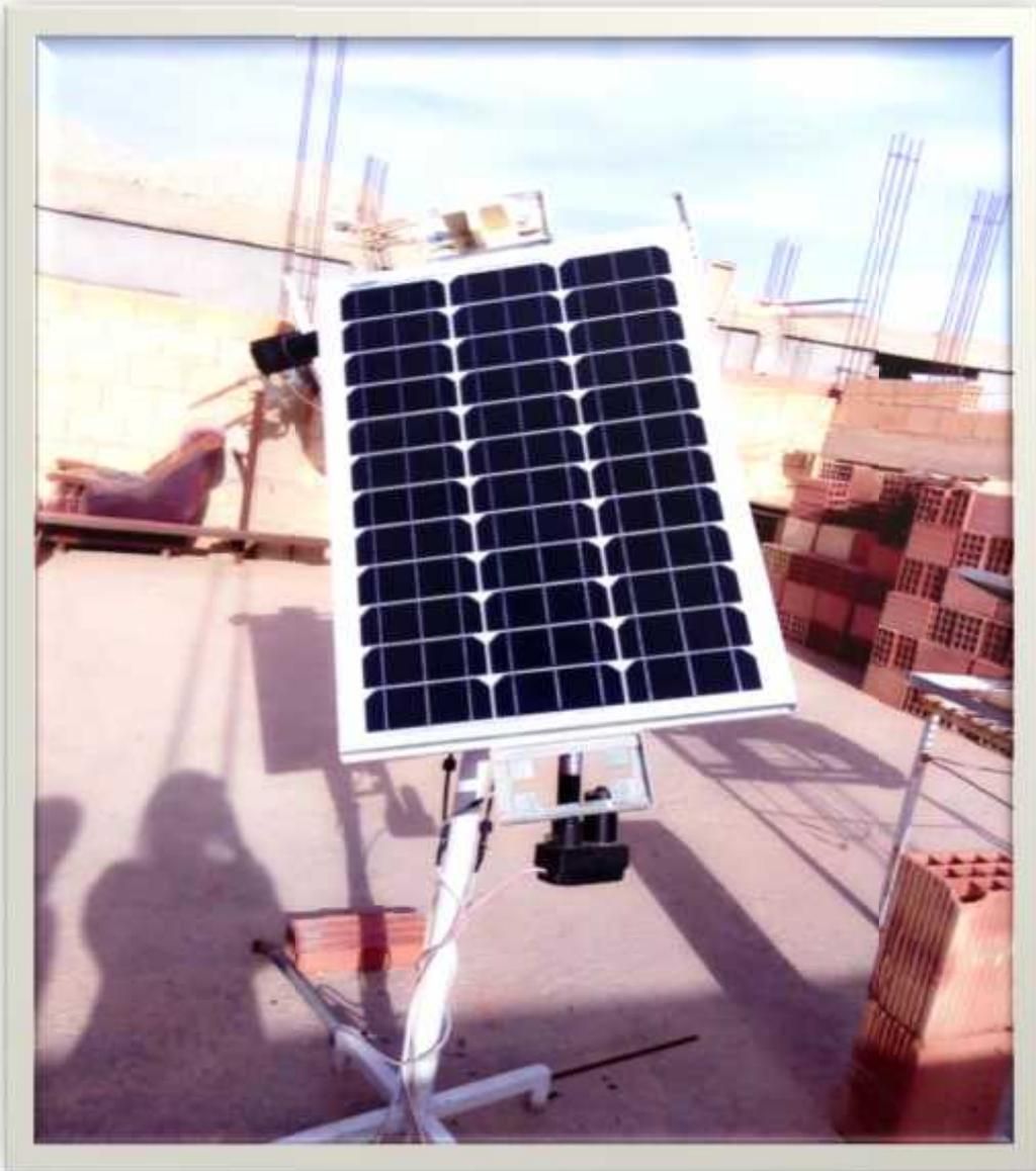
**Figure III .14:** Installation du panneau mobile
