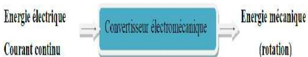
**Figure II.11** : Principe de fonctionnement du moteur à courant continu. [6]
