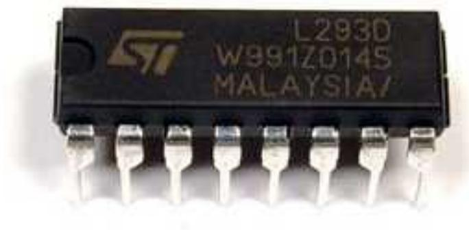
**Figure II.8:** L293D Pont en H double.
