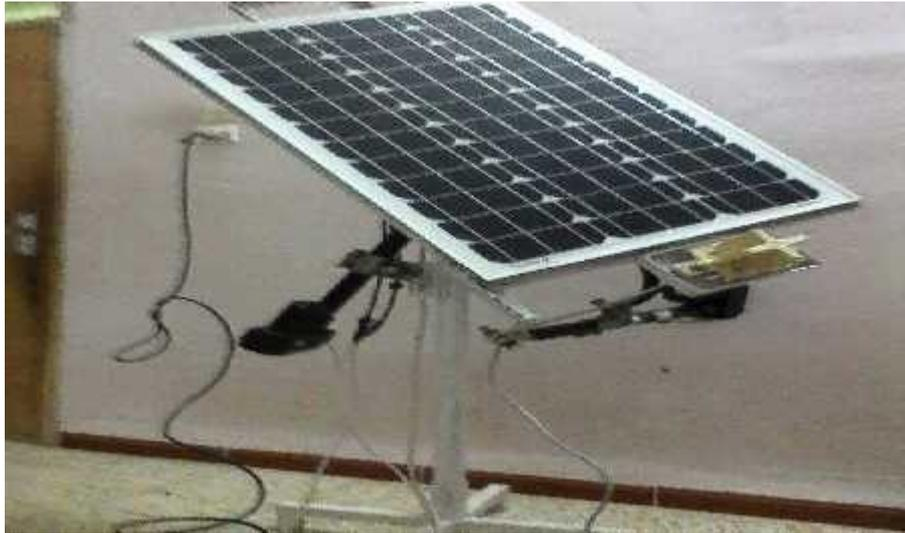
**Figure III .12:** Réalisation du suiveur.
