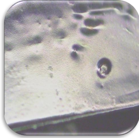
الشكل رقم III. 14: صور لوجهي العينة في درجة حرارة ( 850^{\circ}C ) تحت المجهر الضوئي
