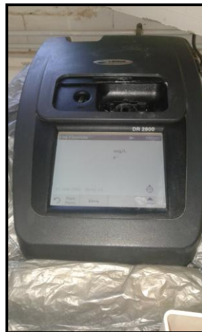
الشكل : (13): جهاز قياس تركيز الفلوريد Spectrophotomètre DR2800. (جهاز المطياف فوق بنفسجي)
