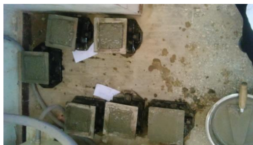
Photo 2.11 : La conservation des éprouvettes avant le démoulage
