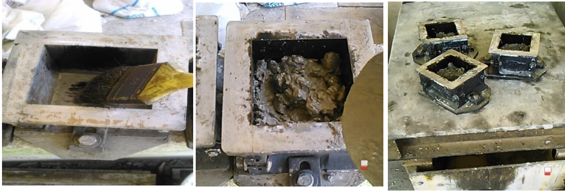
Photo 2.9: La mise en place du béton
