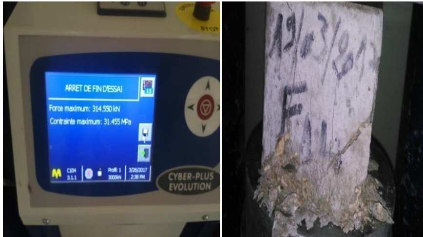
Photo 2.16 : La rupture de l'éprouvette
