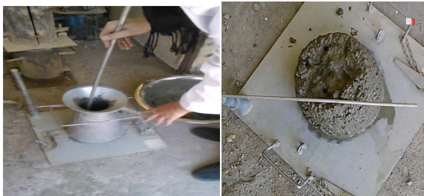
Photo 2.5: Essai de cône d'ABRAMS
