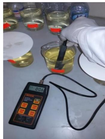
**Figure 09 : mesure de ph et la conductivité**
