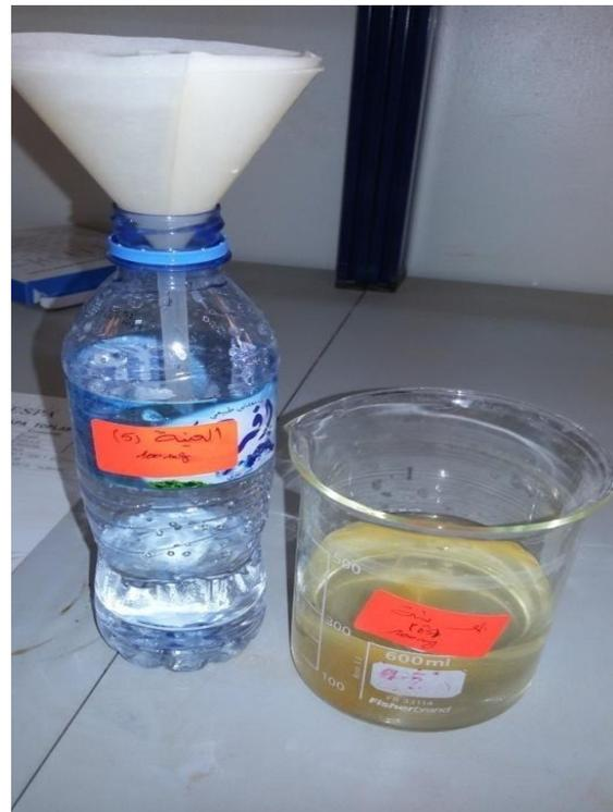
**Figure 02: filtration les échantillons**
