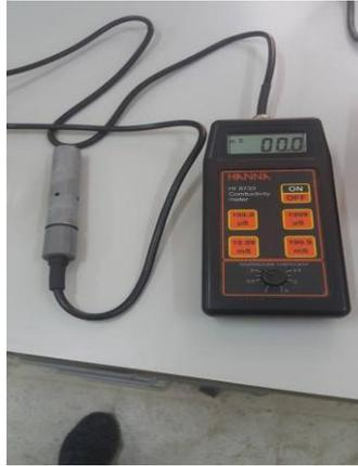
**Figure 07 : conductimètre**
