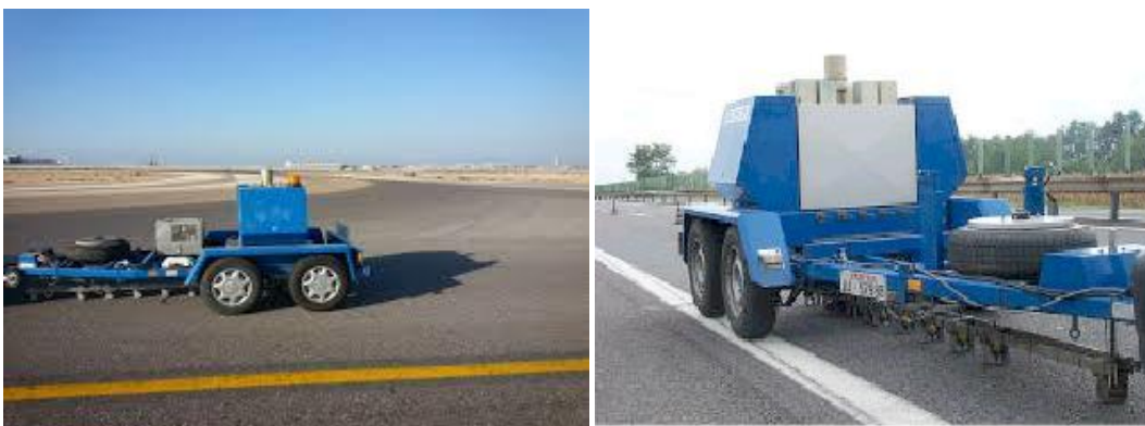
Fig. 1 : HWD (Heavy Weight Déflectomètre)
