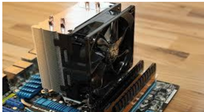
Figure: 1.9. Refroidissement de Microprocesseur par L'air.
