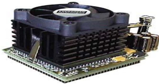
Figure 1.8. Processeur avec son système de refroidissement.
