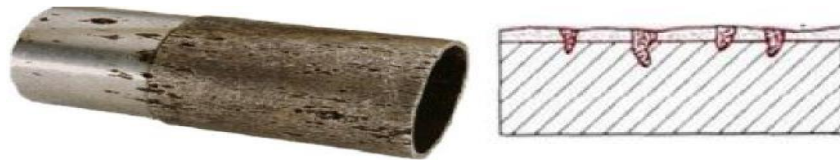
Figure I.2 Corrosion par piqures d'un acier inoxydable [2].
