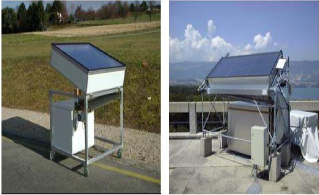
Fig. II.4 : Machine frigorifique à adsorption solaire [12].
