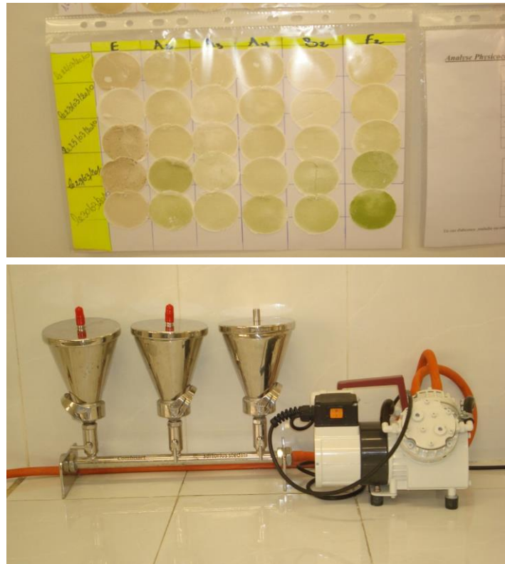
Figure (III-1): Unité de filtration avec pompe à vide.
