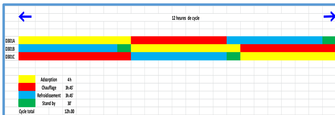
Figure I.3 : Cycle complet (Adsorption + Régénération) du déshydrateur D301A/B/C
