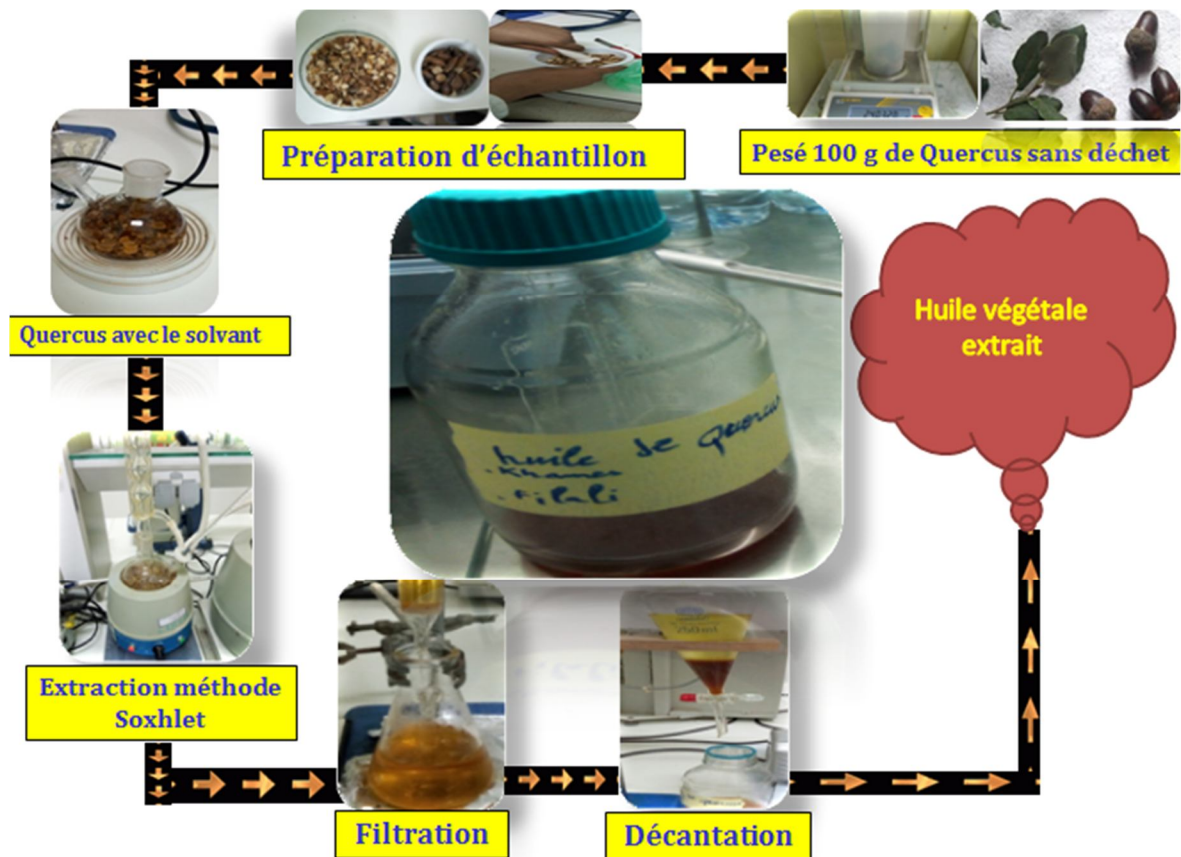
Figure IV.3 : Les étapes de l'extraction
