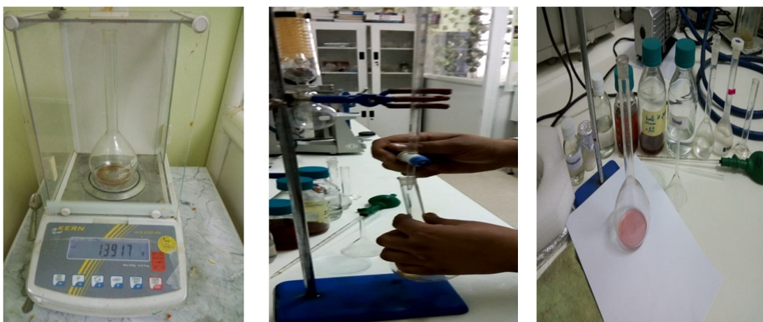
Figure IV.7 : Les étapes de titrage
