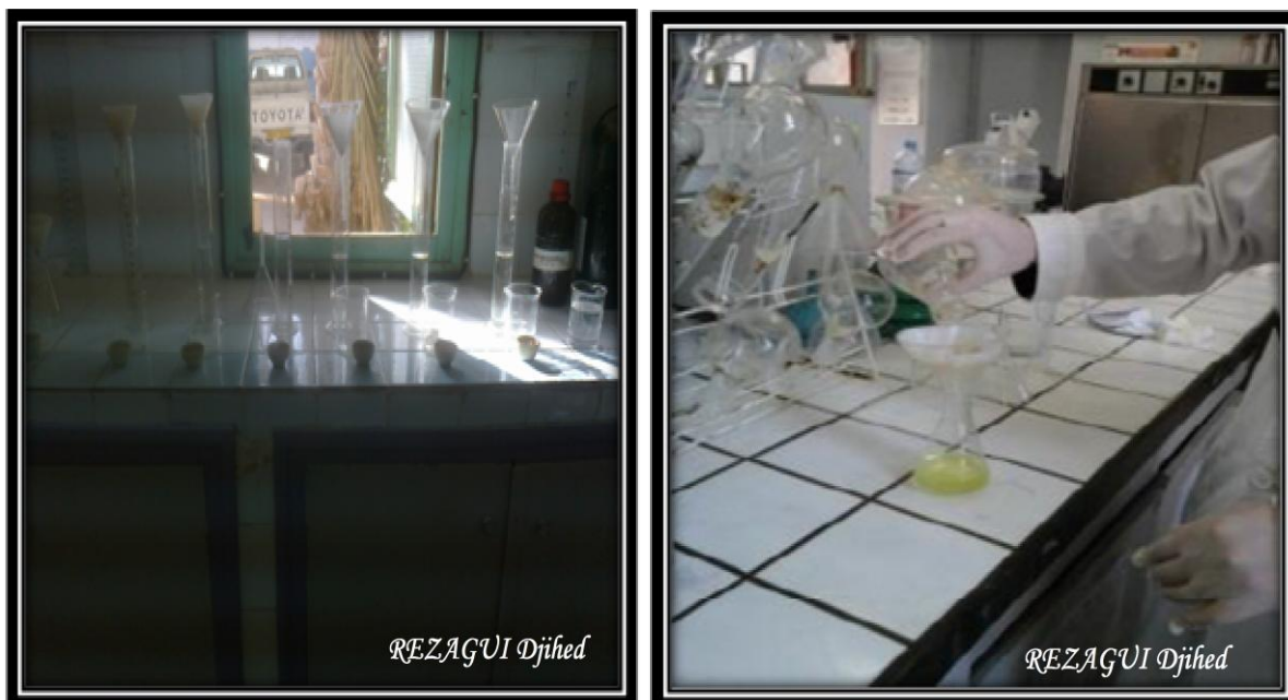
Photo III 22. Dosage de gypse.
