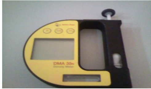
الصورة(4): جهاز قياس الكثافة (Density Mètre)
