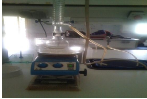
الصورة (10): التركيب المخبري المستعمل في تحضير صابون زيت الضرو.
