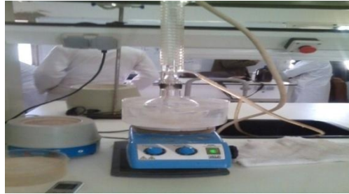
الصورة (12): التركيب المخبري المستعمل في تحضير صابون زيت الزيتون وزيت الضرو.
