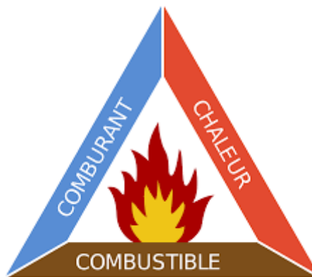
Fig. I. 1: Le triangle du feu de la combustion [1]
