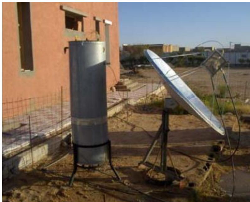
الشكل (II-3): منظومة تسخين المياه بالألياف البصرية [13].
