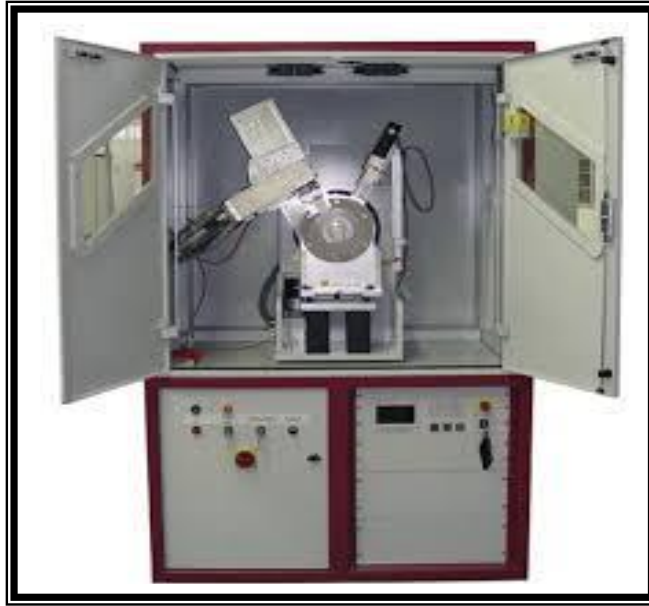
الشكل (1.III) : يمثل صورة لجهاز الأشعة السينية من نوع (XRD 3003 TT).
