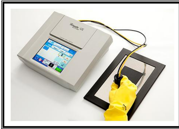
الشكل (8.III): يوضح جهاز قياس الناقلية (Hiresta-UX).
