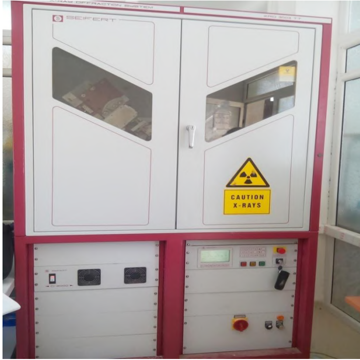
الشكل II-19: صورة لجهاز انعراج الأشعة السينية.
