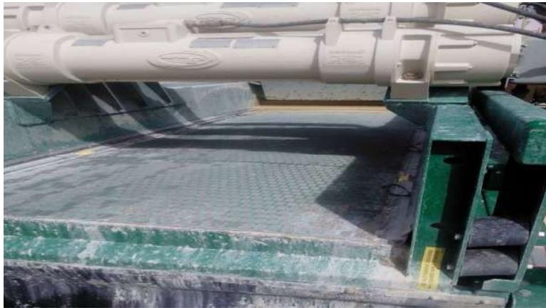
Figure 06 : tamis de vibration
