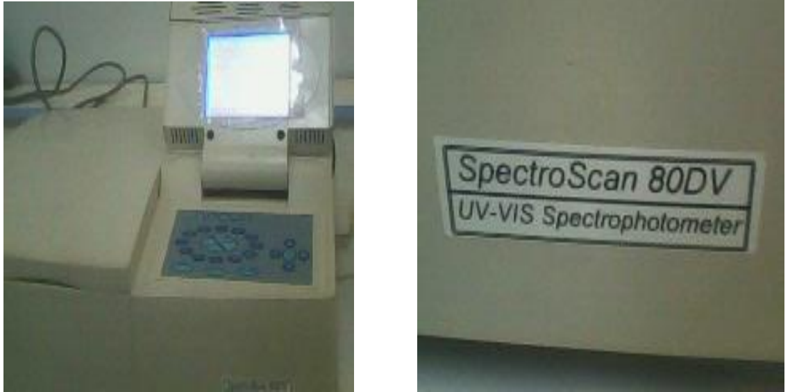
Figure 18 : Spectrophotométrie d'absorption moléculaire UV-visible
