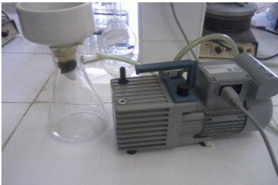
Figure 15 : Filtration sous vide
