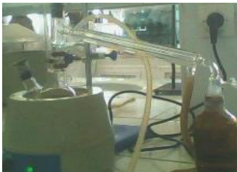
Figure10 : Montage de distillation d'éthanol.
