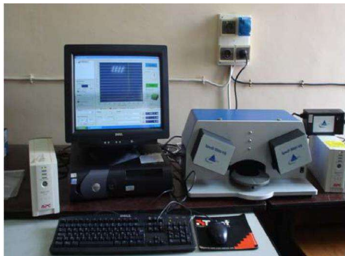
Fig. II.1 : Banc de mesure de l'Ellipsomètre SpecEL2000-VIS.
