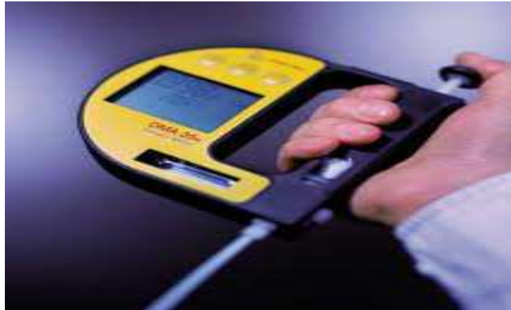
Figure III.2: Densimètre de type DAM 35 N
