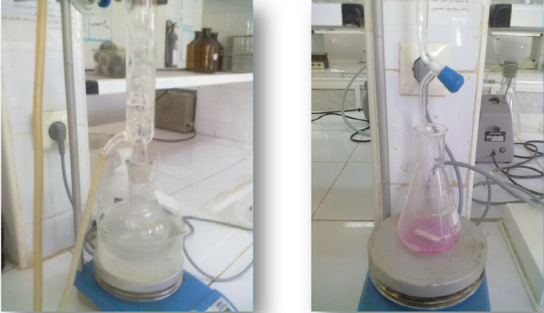
Figure III.7 : Photo : (a) montage de la réaction saponification et (b) de titrage
