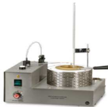
Figure III. 8 : Appareil de mesure point d'éclair
