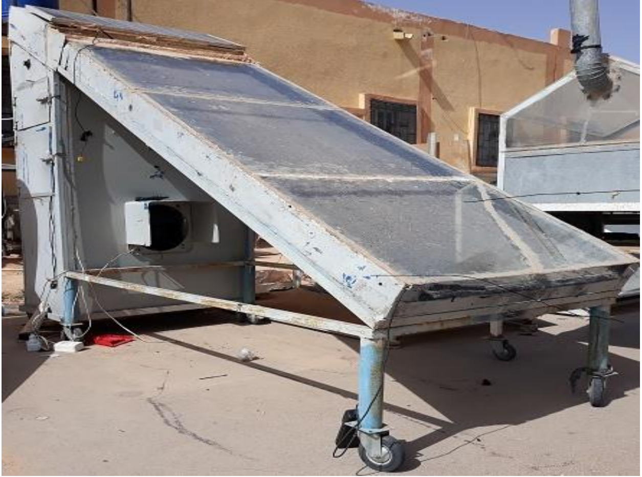
صورة اللاقط الشمسي المسطح المستعمل في التجربة
