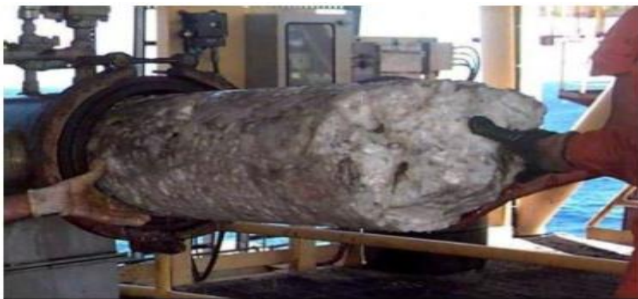
Figure I.7 : Hydrate sorti d'une gare racleur. [4]
