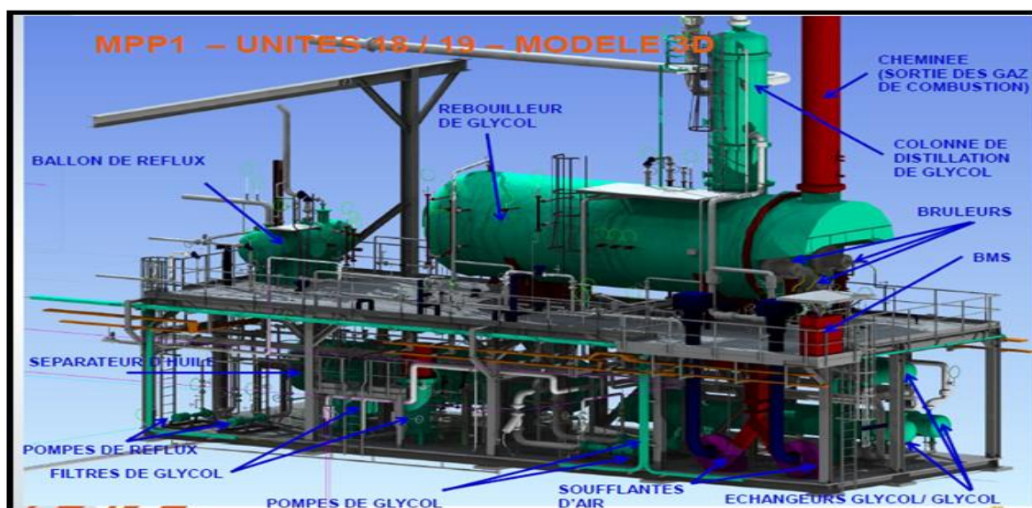
Figure I.18 : Unités de glycol.
