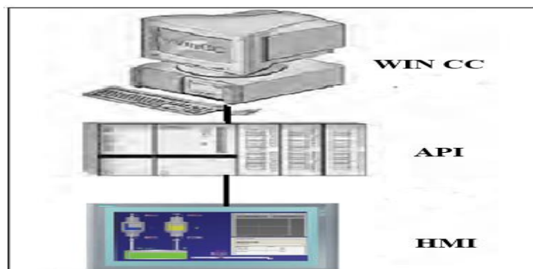
Figure III.2 : Communication entre les trois partie Win CC, API et HMI.
