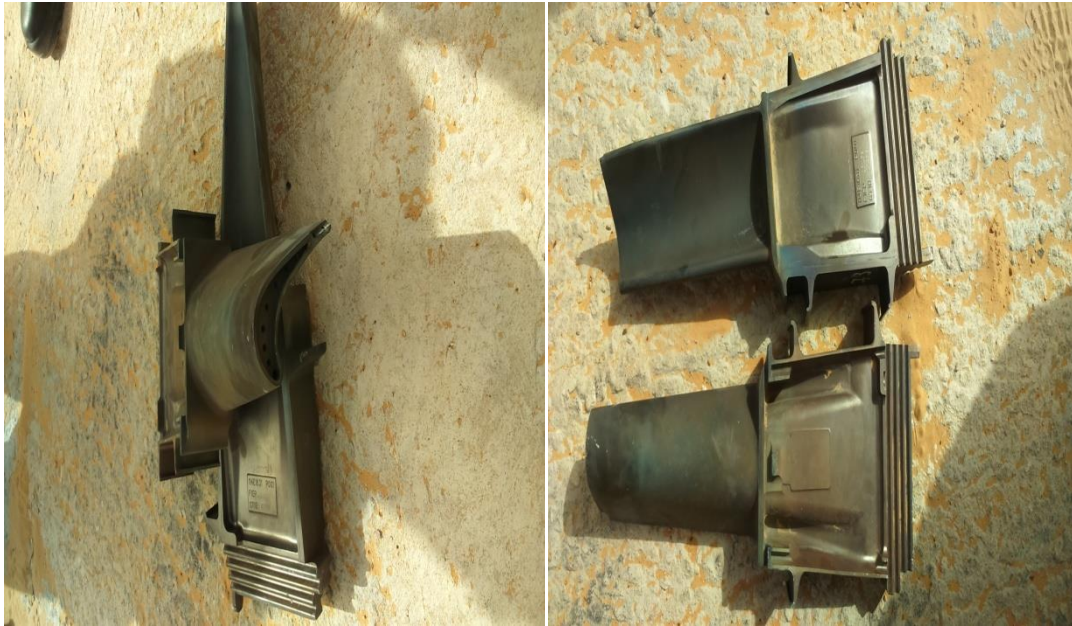
Figure 21 : Vue réel des aubes de turbine à gaz 9E
