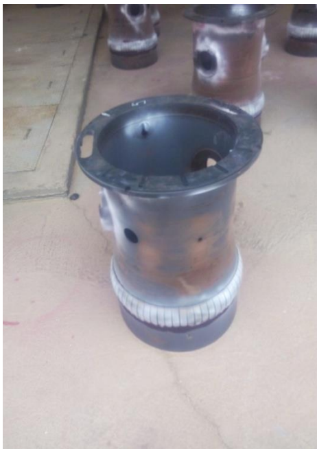
Figure 13 : Vue réel de chemise 9E.
